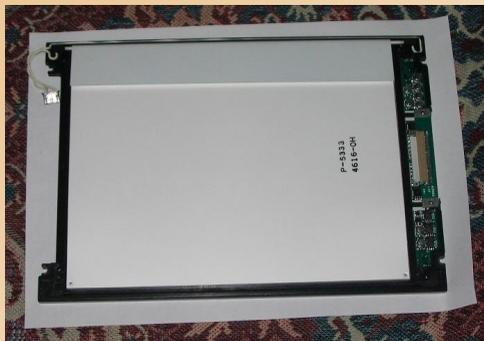
Итак, я разобрал дисплей ноутбука, достал матрицу, открутил заднюю металлическую крышку экрана и достал CCFL лампу. Она в общем то не особо закреплена, всё итак отлично держится... На фотографиях всё это видно. Параметры моей лампы таковы: длина 23,5см, диаметр 2,2мм. Измерял сам. Относительно напряжения питания лампы я так толком ничего и не узнал (вроде около 100V).
