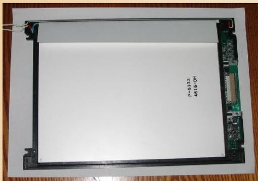
Ставим новую лампу вместо старой, укладываем провода в канавки. Закрываем крышку матрицы. Дисплей пока лучше не собирать, просто положим матрицу на крыш-
