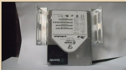
Рис. 15 Жесткий диск с закрепленными салазками
