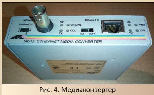
Рис. 4. Медиаконвертер
