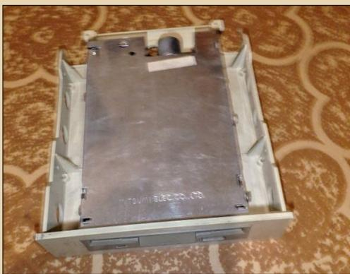
Рис. 4. Дисковод в переходнике – механически он может быть установлен в отсек 5,25", но разъём питания у него как у обычного дисководов (тот дисковод, что достался мне в 2015-м, имел разъём питания как у жёстких дисков и пятидюймовых дисководов)
