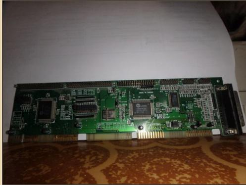
Рис. 9. Только на этой мультикарте удалось заставить мышь, но два IDE-канала для собираемой машины – перебор
