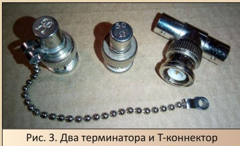
Рис. 3. Два терминатора и Т-коннектор
