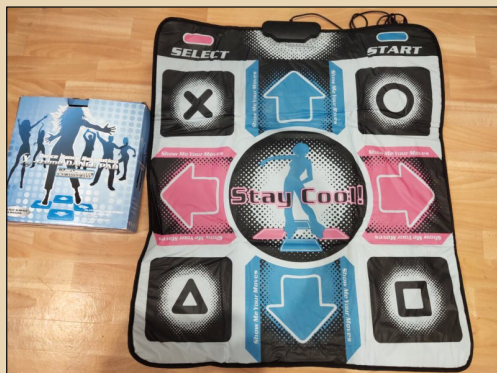
Рис. 9. Коврик для игры в DDR дома. Устройство коврика точно такое же, как и в Power Pad — несколько контактных плёнок в защитном чехле
