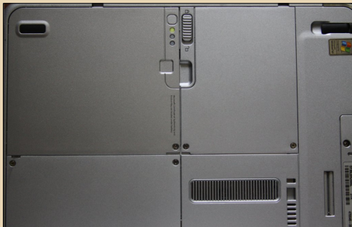
Рис. 3. Уровень остаточного заряда батареи проверить легче лёгкого: нажал на кнопку и определил по светодиодам
