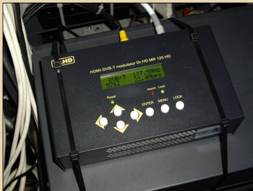
Рис. 6. Модулятор надёжно зафиксирован, чтобы не прыгал от мощных басов со сцены. На экране видны параметры входного и выходного сигналов
