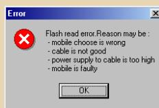
В первом случае стоит попробовать установить другой режим порта, зайдя в настройки BIOS или используя фирменную утилиту, как в случае с моим IBM ThinkPad. По моему опыту, Dejan обычно без проблем работает с режимом EPP. Если это не поможет, тогда, очевидно, придётся диагностировать оборудование.
