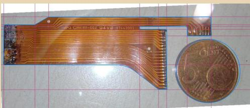
В итоге было нарисовано две версии шлейфа. Вариант, близкий к оригиналу, использующий только один слой и сгибания. И «модернизированная» версия, близкая к Psionex. Для себя я заказал второй вариант, он проще в пайке.
