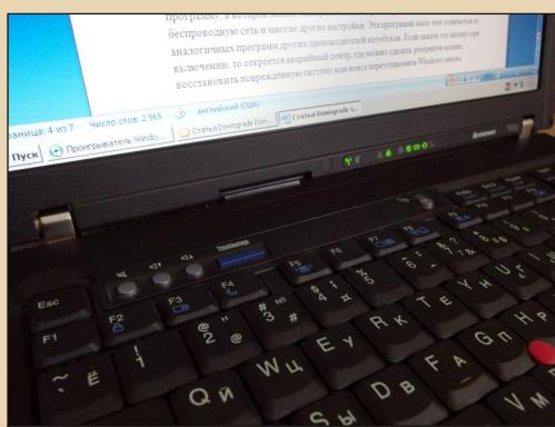
Рис. 5. Кнопки громкости. На фото также видны индикаторы питания, беспроводной сети, кнопки Caps Lock и других функций
