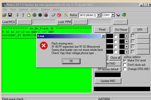
Для записи нужно пользоваться Rolis Flasher 4.78. Она не имеет вышеуказанной проблемы, хотя грешит другой. Если попытаться считать память, то на моменте расчёта контрольной суммы считанных данных программа завершится со сбоем. Поэтому для работы нужно держать две версии одной и той же утилиты.
