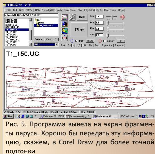
Рис. 5. Программа вывела на экран фрагменты паруса. Хорошо бы передать эту информацию, скажем, в Corel Draw для более точной подгонки
