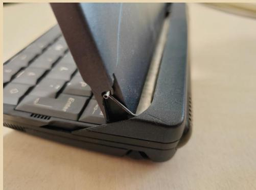
И вторая, самая неприятная и довольно критичная проблема, которая к тому же затрагивает всю линейку Series 5 — крепление тех самых металлических торсионов. С одной стороны они закреплены в крышку с помощью втулок, а с другой — упираются вот в такие пластмассовые фиксаторы.
