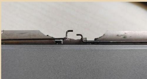
Попытки склеивания фиксаторов с помощью эпоксидного клея нужного эффекта, естественно, не дали, они просто ломаются чуть дальше, что явно намекает об «усталости» пластика. И такие случаи у владельцев «Псионов» отнюдь не редкость.
