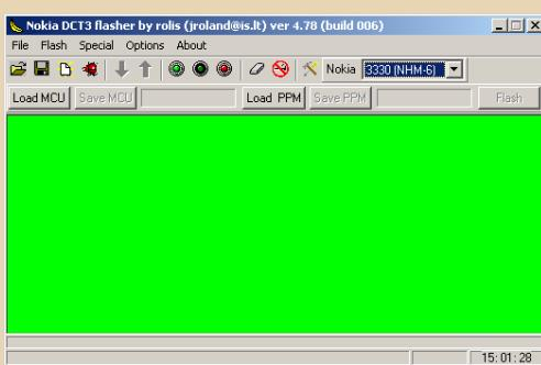
Теперь нажимаем на тёмно-красную кнопку и выбираем сделанный PMM Managerом FLS-файл. После этого появляется уже знакомое нам окно выбора адреса. Адрес записи, естественно, тот же — **0x570000**. Подтверждаем, опять нажимаем на телефоне клавишу включения. Начнётся процесс стирания памяти. После — процесс записи. Они проходят быстрее, чем чтение, так что долго ждать не придётся. И вот когда процесс закончен — можно отключить телефон от кабеля.
