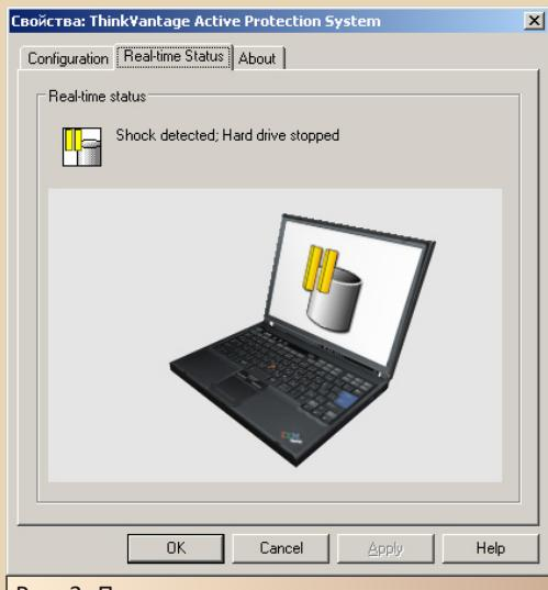
Рис. 3. Программа в реальном времени показывает угол наклона ноутбука и останавливает жёсткий диск, если это необходимо
