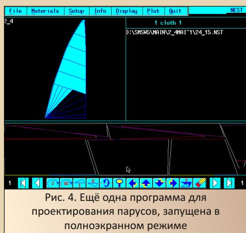
Рис. 4. Ещё одна программа для проектирования парусов, запущена в полноэкранном режиме
