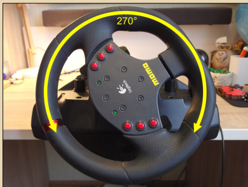
Рис. 4. Руль поворачивается из крайнего левого в крайнее правое положение на 270 градусов. Если смотреть из центрального положения, то это примерно половина оборота
