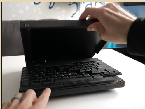
Рис. 6. Клавиатура состоит из двух частей, которые соединяются с помощью особого механизма
