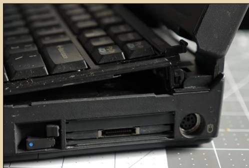
Рис. 8. Автоматический наклон клавиатуры. В разы повышает удобство работы с длинными текстами
