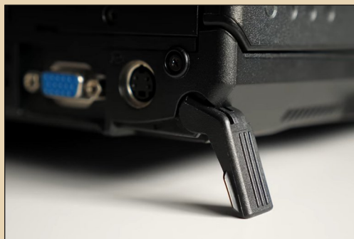
Рис. 5. Ножки — обязательный атрибут клавиатур. В ноутбуках встречаются крайне редко
