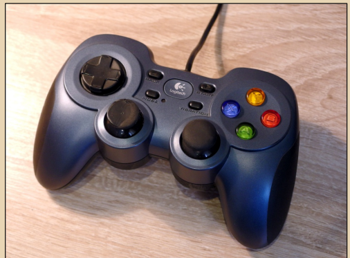
Рис. 3. Геймпад Logitech F510. Здесь есть вибромоторы, работающие в трёх разных режимах
