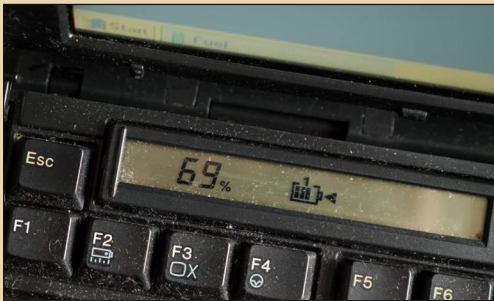
Рис. 10. Дополнительный экран в ноутбуке ThinkPad 760ED. Похожими экранами комплектуются цифровые фотоаппараты
