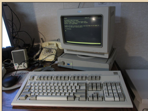
Рис. 7. Терминал IBM 3161 с клавиатурой Model M. Источник фото:
