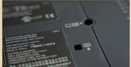
Рис. 11. Дренажные отверстия в клавиатуре. Поверим инженерам IBM на слово – вряд ли кто-то захочет специально проверить их в работе
