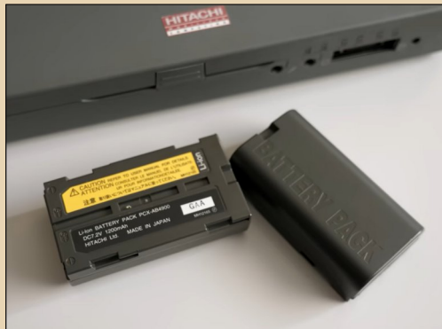
Рис. 3. Сменные аккумуляторы субноутбука ThinkPad 235 (и Hitachi)
