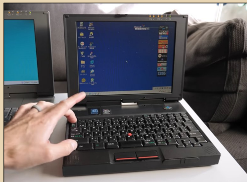
Рис. 2. Ноутбук ThinkPad 235. Помимо быстрого доступа к BIOS есть ещё доступ к дополнительным настройкам ноутбука по нажатию Fn+A
