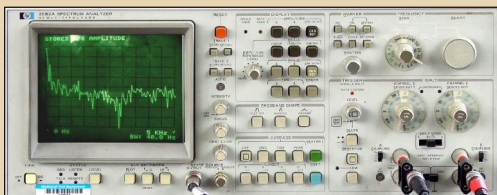
Рис. 4. Двухканальный анализатор Hewlett-Packard 3582A. Самая популярная и продаваемая модель на рынке стоимостью 12 000 $ и весом всего 25 кг (здесь и далее фотографии взяты из архива учебных материалов компании Meyer Sound)
