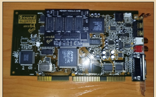
Сейчас можно «прокачать по максимуму» AWE64 Gold установкой «новодельного» модуля памяти на 24/28 МБ
