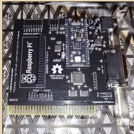
PicoGUS от Polpo в версии E1MAGIC с разъёмом для установки дочерней платы MT32-Pi
