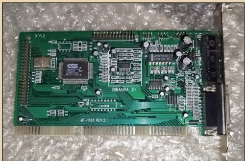
Относительно редкая модификация ESS1868 со схемой Binaura 3D
