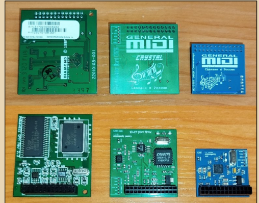
Примеры «дочерних плат» MIDI. Слева направо: DIAMOND AdWawe32 (1997 год), Crystal CS9236 (чип 1997 года, плата – новодел), Dream SAM2695 (чип 2014 года, плата – новодел)
