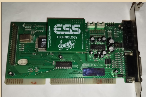
ESS1868 после «апгрейда» дочерней Wave-платой на базе чипов ESS
