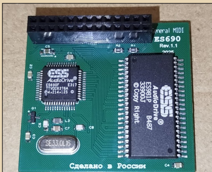
Дочерняя плата ESS: табличный синтезатор ES690F и ПЗУ на 1 МБ ES981P
