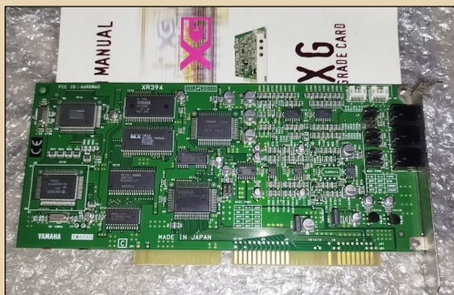
Волновой MIDI XG-синтезатор Yamaha SW60XG на отдельной ISA-плате
