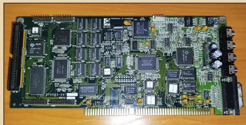
Рис. 3. Звуковая карта Logitech SoundMan Wave (после небольшого ремонта)
