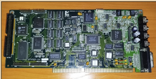
Рис. 3. Звуковая карта Logitech SoundMan Wave (после небольшого ремонта)
