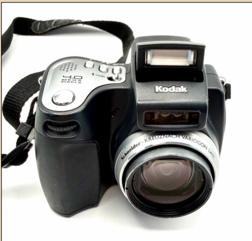
Рис. 5. Фотоаппарат Kodak EasyShare DX6490 с невероятным для тех лет зумом 10х. Современные ультразумы Kodak обладают увеличением 52х. Фото JLLuckyFinds
