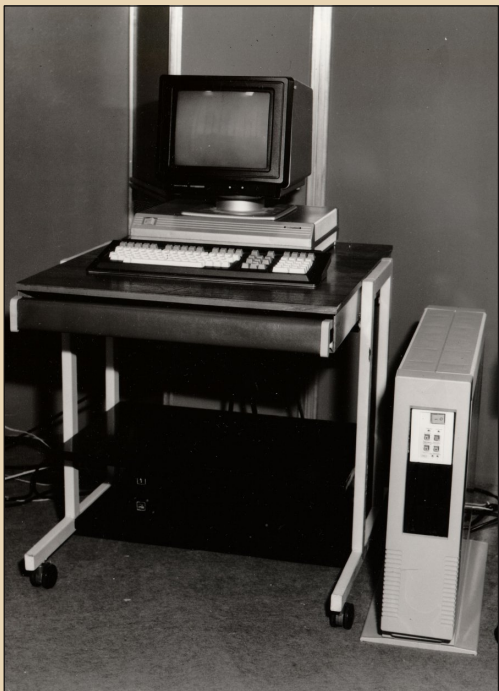
Рис. 8. Вычислительный комплекс «Электроника МС 0104» с цветным графическим терминалом МС 7105
