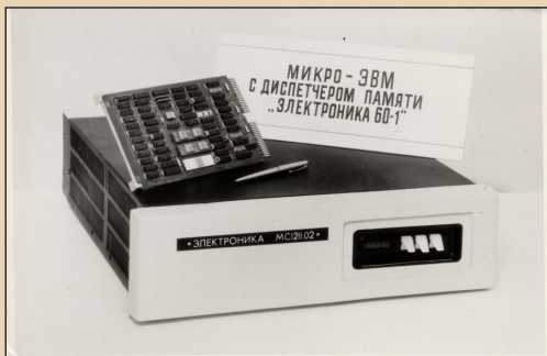
Рис. 4. МикроЭВМ «Электроника МС 1211.02» с диспетчером памяти «Электроника 60-1»
