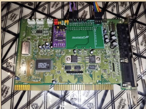
Рис. 11. Wavetable-Pi, установленный на звуковую карту Sound Blaster 16 (CT2960) – отличная машина для воспроизведения MIDI!
