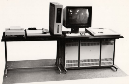
Рис. 11. Предположительно, это АРМ для работы с графикой (или чертежами) на базе «Электроника МС 0104»
